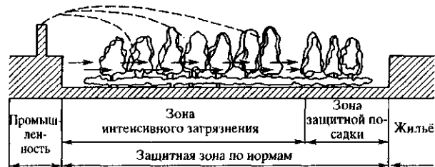
Рис. 1.5. Совмещенная схема движения загрязненных нижнего и верхнего потоков
