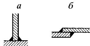
Рис. 12.3. Сварка втавр (а) и внахлест (б)
